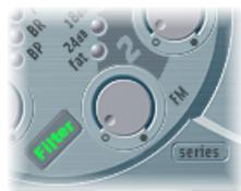
L'effet de telles modulations de filtre sur le spectre audio reste difficilement prévisible. Toutefois, les résultats obtenus semblent toujours harmonieux si vous évitez les valeurs élevées d'intensité de modulation. Le paramètre FM est utilisé pour définir l'intensité de la modulation de fréquence de ce filtre.
