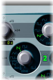
**Astuce :** utilisez les signaux d'entrée en dents de scie et rectangulaire (modulés sur la largeur d'impulsion) provenant respectivement des oscillateurs 1 et 2, pour créer un signal de sortie beaucoup plus complexe. L'utilisation de ces formes d'onde riches en harmoniques crée un certain nombre de bandes latérales supplémentaires, devenues audibles.
