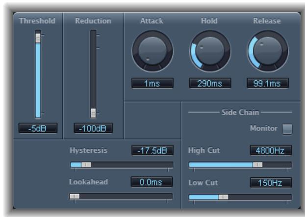
La figure ci-dessus présente un réglage Threshold bien adapté à la compression de la parole. Les filtres sidechain dédiés du module Noise Gate évitent un déclenchement intempestif par un bruit de fréquence basse ou aiguë. Les valeurs Hold, Release et Hysteresis conviennent pour la plupart des signaux vocaux et de parole.
