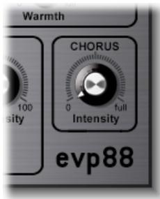
Le paramètre Chorus régule l'intensité (valeur de la déviation du temps de retard). La vitesse du LFO est fixée à 0,7 Hz, mais elle peut être modifiée à l'aide du paramètre Chorus Rate (consultez [Utilisation des paramètres EVP88 Extended](#) ci-dessous).
