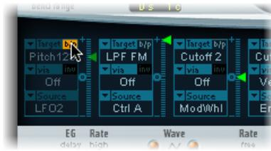
Le paramètre de contournement (b/p) permet d'activer ou de désactiver les routages de modulation individuels, sans perdre les réglages.
