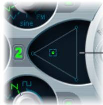
Cliquez sur le triangle, ou cliquez et faites glisser dans le triangle, pour modifier la balance de niveau entre les oscillateurs.
