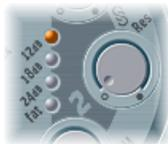
Le filtre 2 propose trois pentes différentes : 12 dB, 18 dB et 24 dB par octave. Plus la valeur de pente est élevée, plus la pente est raide et plus l'atténuation au-delà de la *fréquence de coupure* est marquée pour chaque octave.
