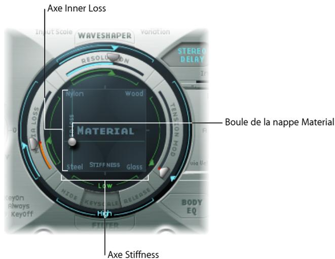
Le paramètre *Inner Loss* est utilisé pour émuler l'atténuation de la corde provoqué par son matériau : acier, verre, nylon ou bois. Les pertes varient en fonction de la fréquence, ce qui se traduit par un son devenant plus doux au fil de la phase de chute du niveau.
