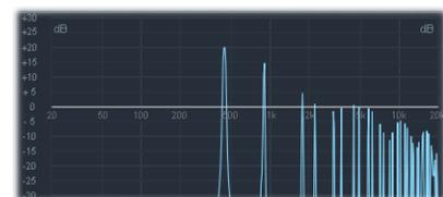
La forme d'onde carrée peut être modifiée sur la plupart des synthétiseurs, pour que les cycles (ou impulsions) soient plus rectangulaires, grâce à une commande de modulation d'impulsions en durée (MID). Plus l'onde devient rectangulaire, plus le son est nasal. Avec ce type de modulation, l'onde carrée prend le nom d'*onde pulsée* et contient moins d'harmoniques. Elle peut être utilisée pour les sons de cuivre, de basse et d'instrument à anche. Consultez [Modification de la forme d'onde](#).
