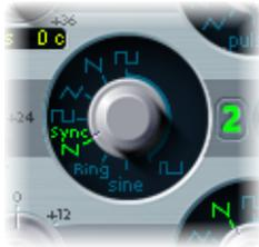
À chaque fois que l'oscillateur 1 entame une nouvelle phase, l'oscillateur synchronisé (2 ou 3) est forcé de repartir au début d'une phase. Entre les cycles de formes d'onde de l'oscillateur 1, les cycles de formes d'onde des oscillateurs synchronisés se déroulent librement.
