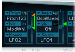
La cible de modulation est Pitch123. Cela signifie que la hauteur tonale (paramètre Frequency) des oscillateurs 1, 2 et 3 est affectée (par LFO2, la source de modulation).
